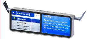
Die Leistung des Bordrechners ist dabei so beachtlich, dass neben Fahrgastinformation auch gleichzeitig Entertainment für den Fahrgast zur Verfügung steht. So können zum Beispiel gleichzeitig zwei 720p HD Videos dekodiert und dargestellt werden. Die CPU wird durch Hardwaredekodierung hierbei nicht belastet.
