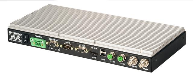
Der VIANOVA Fahrzeugserver ist ein speziell für mobile Anwendungen entwickelter Bordrechner. Er ist die Hardwareplattform für die VIANOVA Softwareprodukte wie Fahrgastinformation, Entertainment, Videoüberwachung und Fahrgastzählung. Die Rechenleistung ist optimal dimensioniert, um alle Applikationen gleichzeitig mit Leistungsreserven zu unterstützen.
